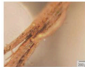
IMAGES MICROSCOPIQUES DE LA SURFACE DES FIBRES DE XYLIT ET DES MICRO-ORGANISMES SUR LES FIBRES.
