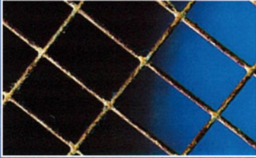
Treillis galvanisé après tests de 5 ans
